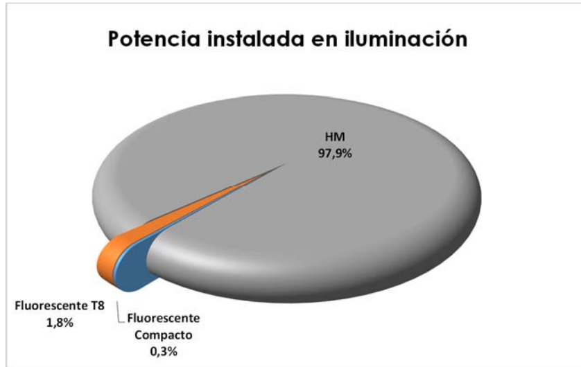
Gráfica 4. Distribución de la potencia instalada en iluminación según tipo de lámpara
